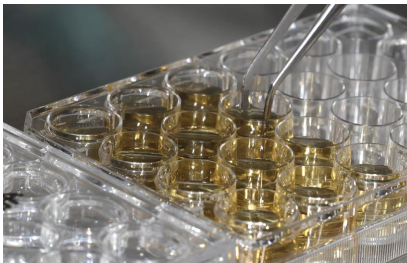
Figura 8 - Disco de titânio sendo transferido para o poço com BHI caldo após o segundo tratamento do dia.
