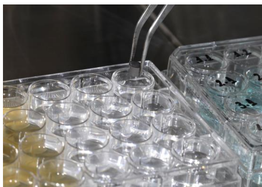
Figura 5 – Disco de titânio de superfície tratada recebendo a lavagem com solução salina 0,89% previamente ao mergulho dentro das soluções a serem testadas.
