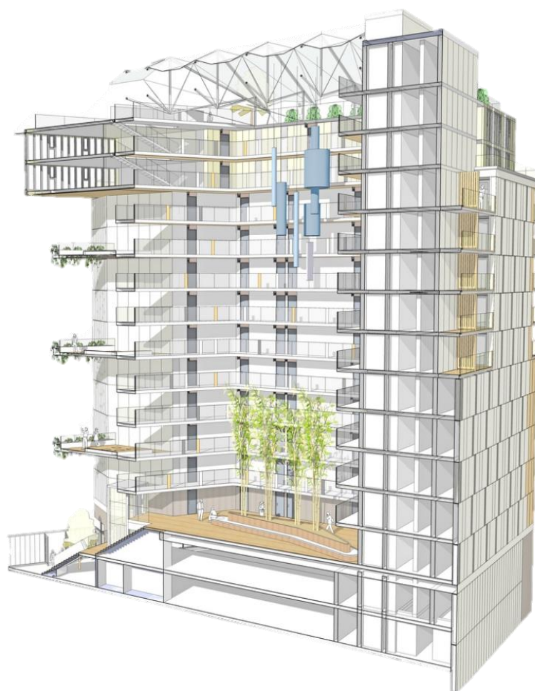
Figura 58 - Corte esquemático do prédio demonstrando a distribuição dos pavimentos
