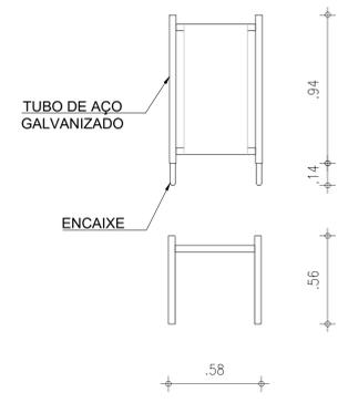
03 DETALHAMENTO - MÓDULO DE ENCAIXE
