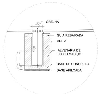
02 DETALHAMENTO DE ESCOAMENTO DE ÁGUAS PLUVIAIS
