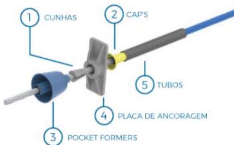
Figura 14 – Acessórios componentes do sistema de protensão não aderente
