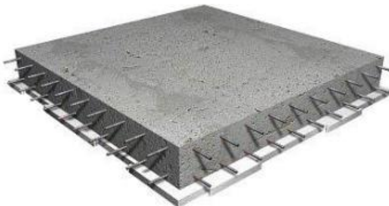
Figura 2 – Representação de laje maciça em concreto armado
