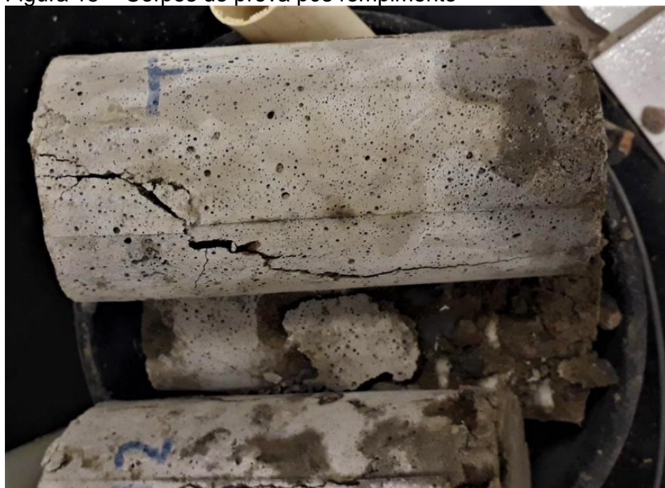
Figura 15 – Corpos de prova pós rompimento
