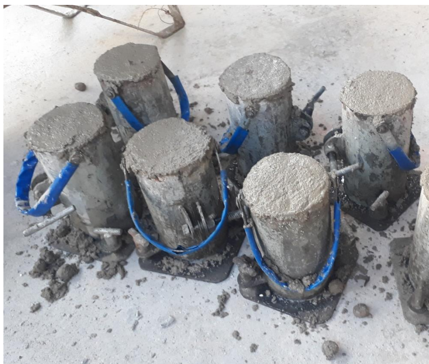
Figura 11 - Corpos de Prova nos moldes cilíndricos
