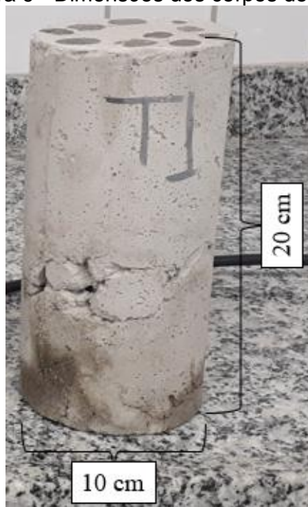
Figura 9 - Dimensões dos corpos de prova
