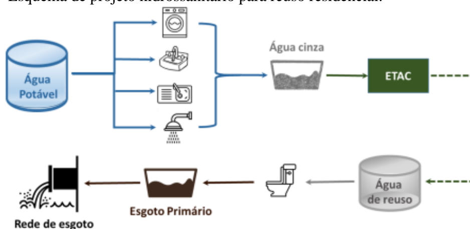
Figura 7 – Esquema de projeto hidrossanitário para reuso residencial.
