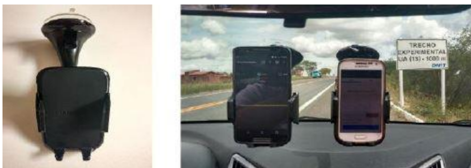
Figura 13 – Suporte e posição que o aparelho deve ficar durante a avaliação
