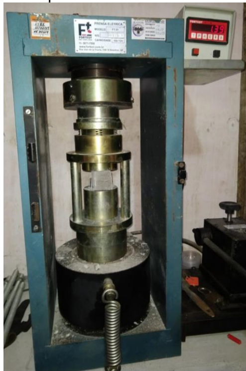
Figura 16 – Ensaio de resistência a compressão axial
