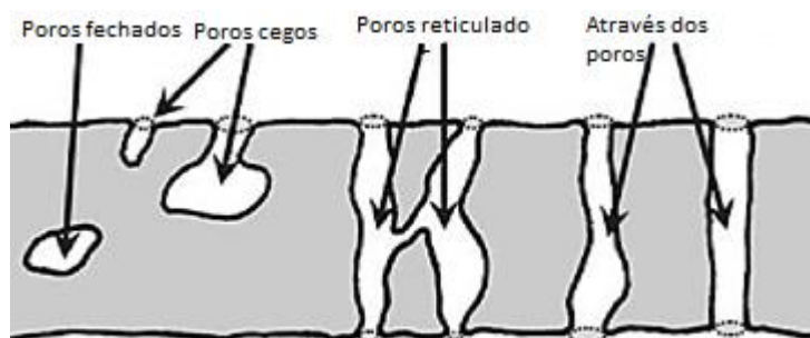
Figura 4 – Representação esquemática dos poros na argamassa
