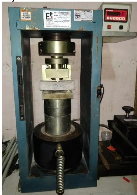
Figura 15 – Ensaio de resistência a tração na flexão
