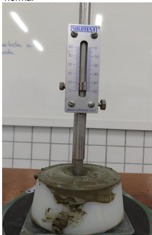
Figura 12 – Ensaio de consistência normal
