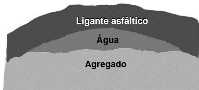
Figura 9 - Falha de adesão interfacial agregado-asfalto
