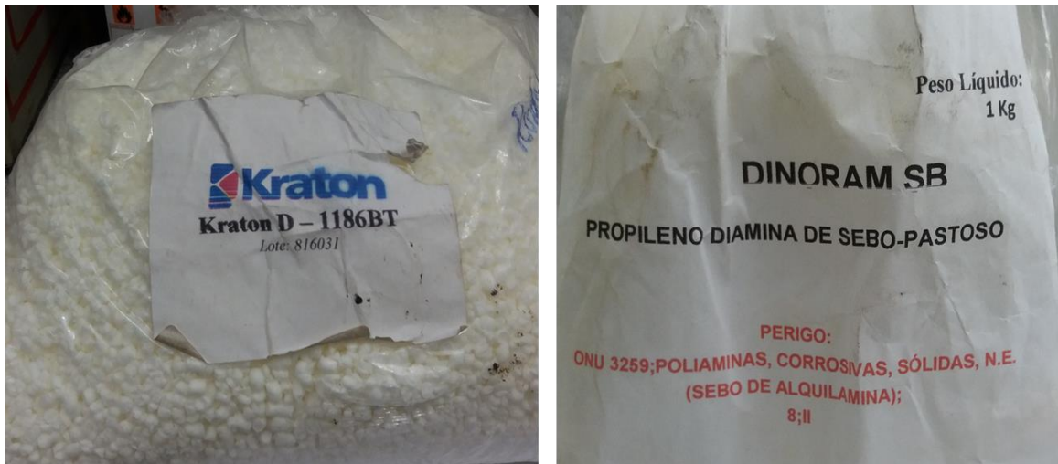
Figura 11 - Materiais utilizados na modificação do ligante: SBS e surfactante
