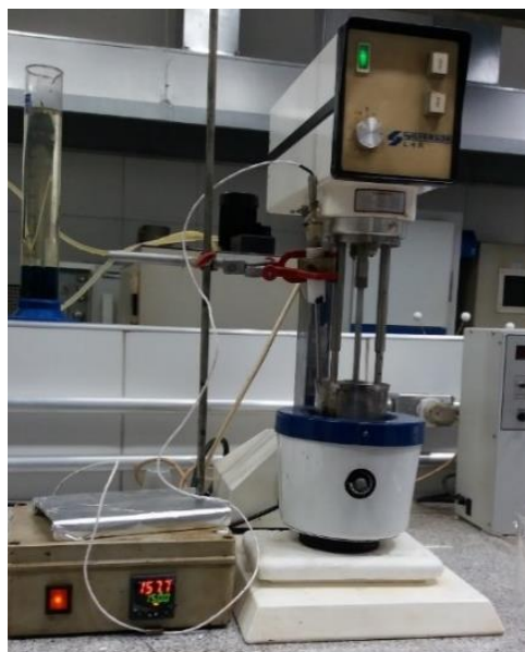
Figura 12 - Equipamento Silverson L4R de alto cisalhamento
