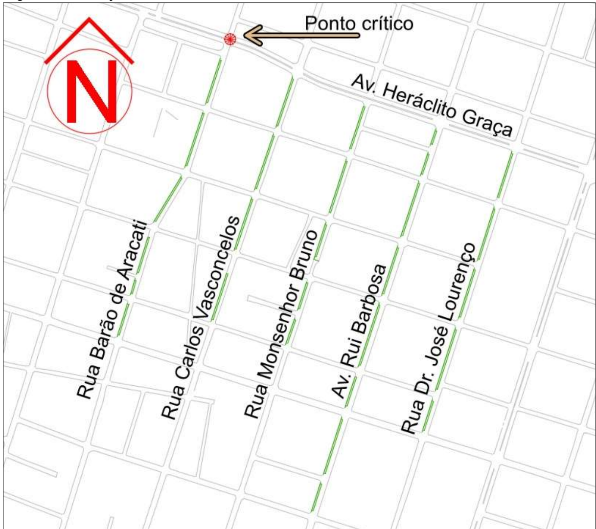
Figura 29 – Alocação de Pavimento Permeável.
