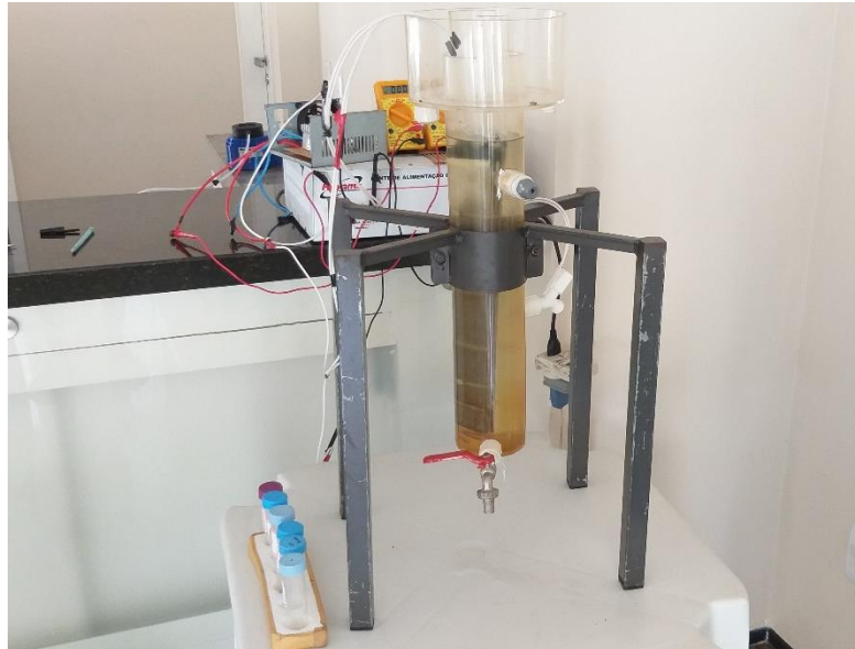
Figura 13 - Reator eletrolítico operado em batelada.
