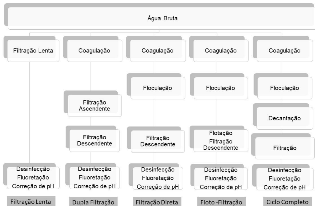
Figura 3 - Principais tecnologias usadas no tratamento de água para consumo humano.
