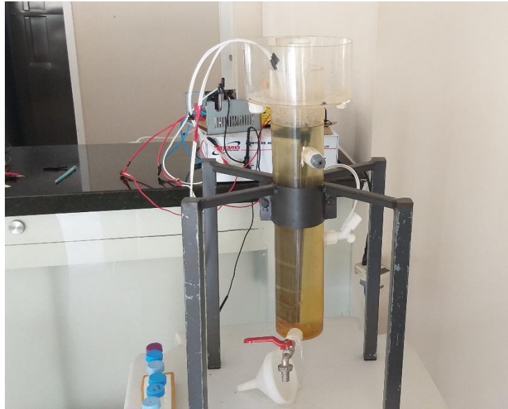
Figura 22 - Reator eletrolítico em formato cilíndrico
