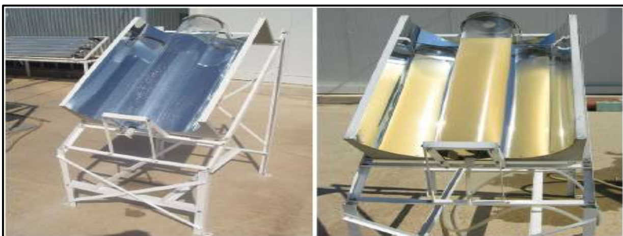
Figura 12 – Reator de SODIS na Plataforma Solar de Amería na Espanha com 25L contendo água de 0 e 100 NTU
