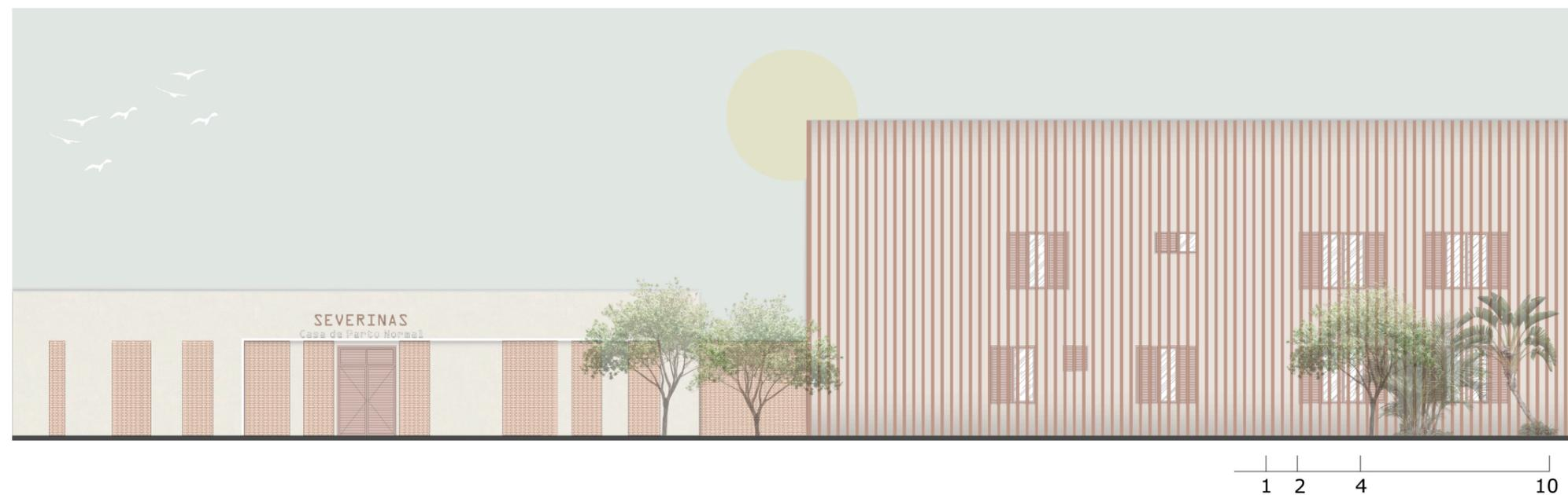
Quanto à fachada 06 (ver figura 96), os elementos foram pensados de forma a trazer proteção solar, tendo em vista que boa parte dela está voltada para o oeste. Dessa forma, no bloco maior, foi criada uma segunda parede que possui uma distância de um metro da parede mais interna, a qual possui poucas esquadrias, sendo elas venezianas.
