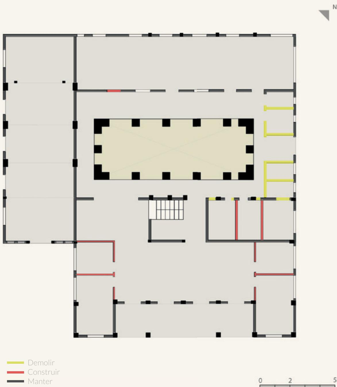
**Figura 3.30** Planta baixa demolir/construir do pavimento térreo.
