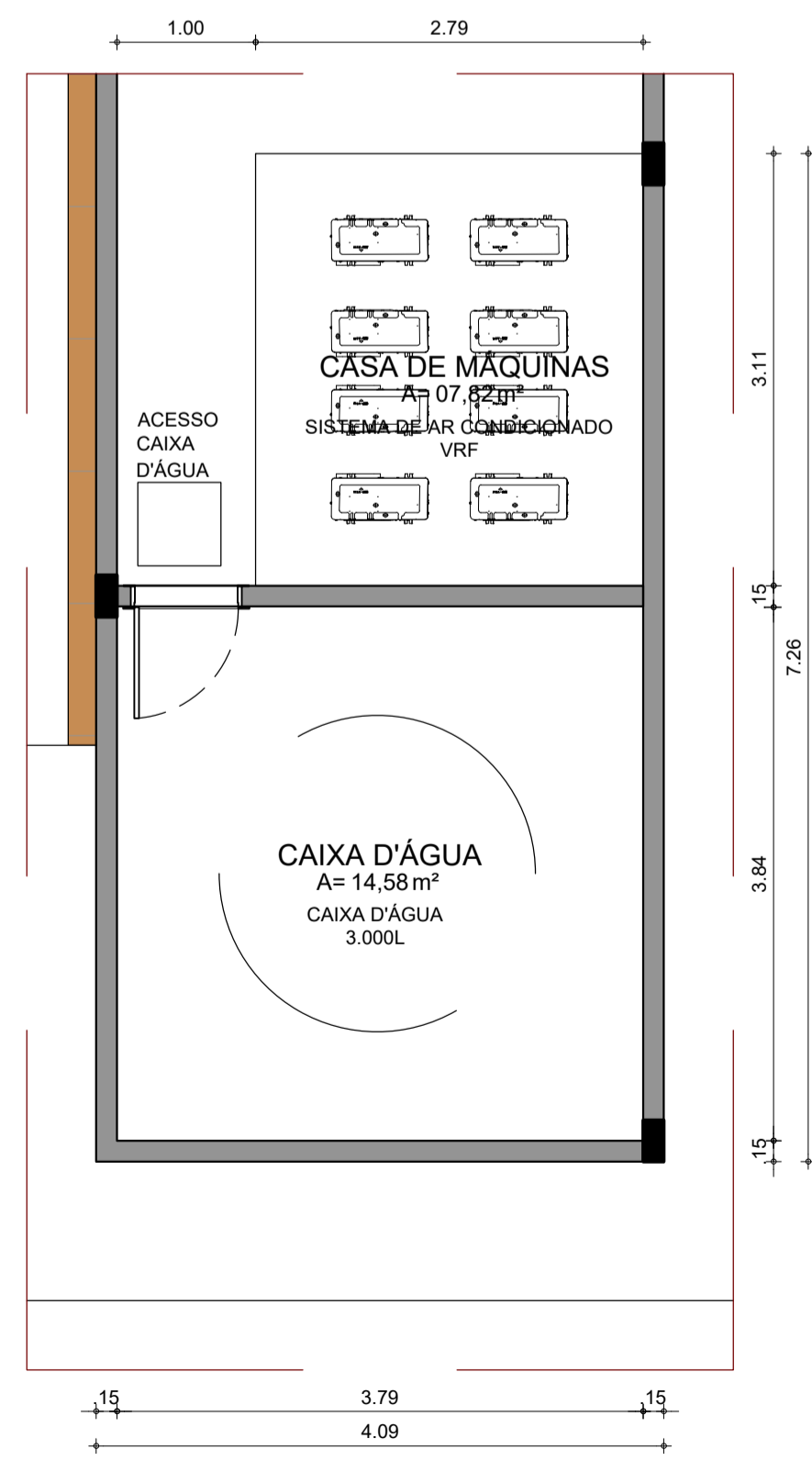
02 CAIXA D'ÁGUA E CASA DE MÁQUINAS ESCALA 1/50
