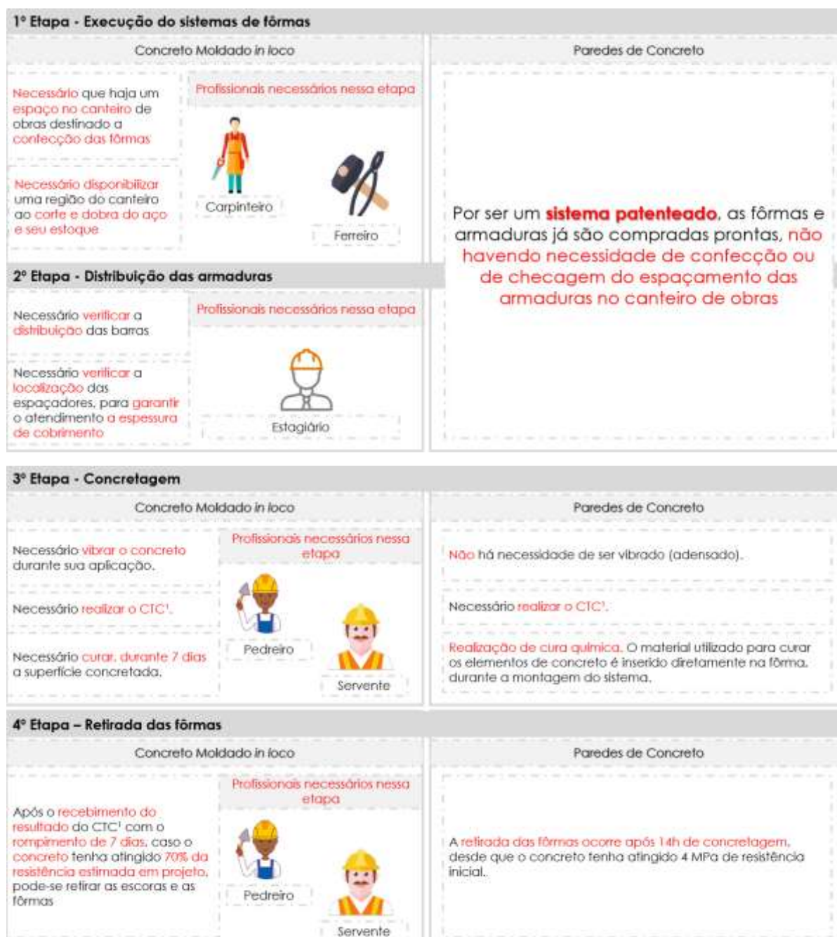
Figura 3 – Visão geral do processo executivo de estruturas de concreto armado moldado in loco x Parede de Concreto
