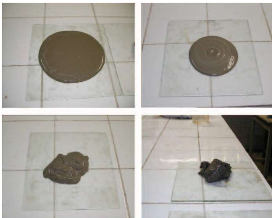
Figura 2: Pasta do mesmo cimento Portland com diferentes relações água/cimento
