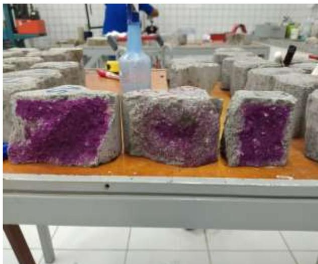
Assim como ocorreu o ensaio de fenolftaleína nas peças de pavimento intertravado de concreto com 16 faces, nas peças retangulares também foi realizado o mesmo ensaio após o rompimento das peças. A seguir, nas Tabelas 15, 16 e 17, são mostrados os valores de profundidade de carbonatação de cada amostra e os valores médios dessa profundidade para as peças que sofreram procedimento de carbonatação natural, carbonatação induzida e sem carbonatação respectivamente.
