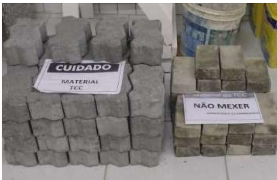
Para a etapa de carbonatação das peças, foi utilizado um isopor com capacidade de 170 L, no qual as peças de pavimento intertravado foram inseridas. Para a simulação da carbonatação foi inserido o CO<sub>2</sub> por meio de um extintor, conforme Figura 18 a seguir. O isopor foi vedado, sendo aberto somente no momento da inserção do CO<sub>2</sub>, e logo em seguida novamente fechado, afim de haver uma maior exposição dos objetos em estudo ao efeito de carbonatação.
