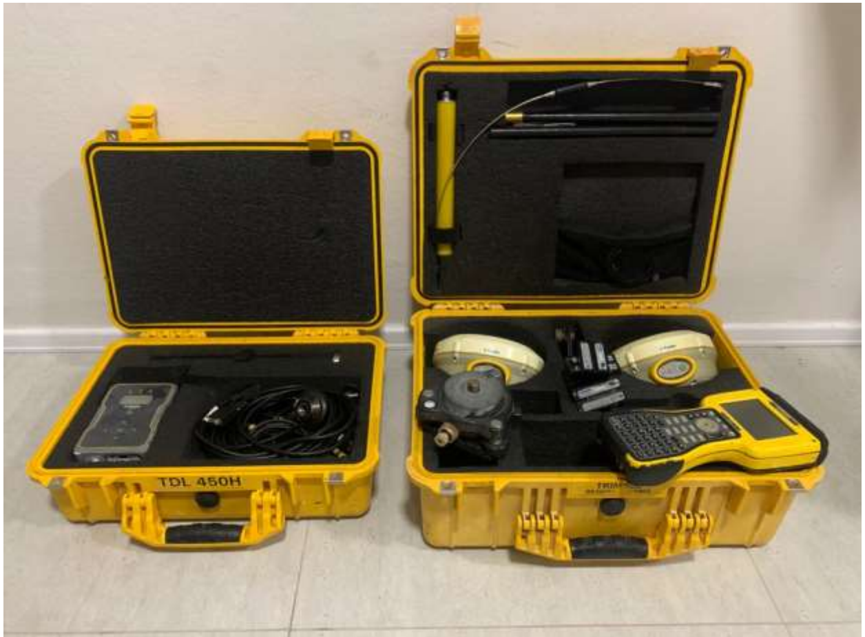
Figura 24 – GPS geodésico R4 L1/L2, Bateria 60Ah, Tripé em Metal e Bastão de fibra de carbono de 2 m.
