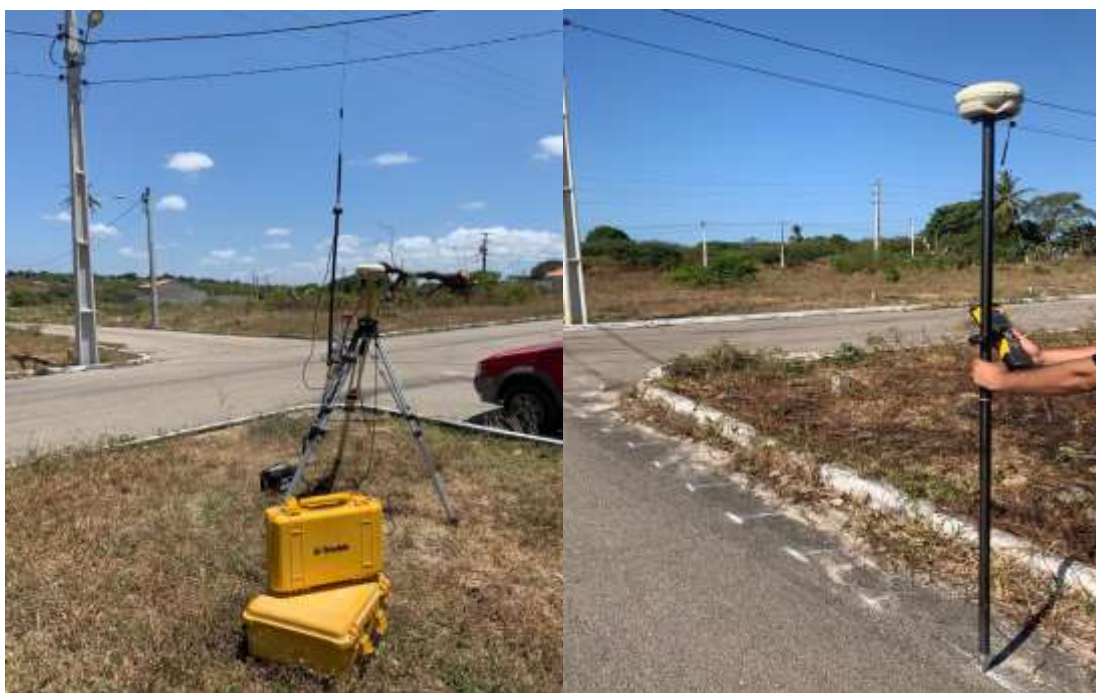
Figura 30 – Levantamento com GPS em modo PP/RTK.
