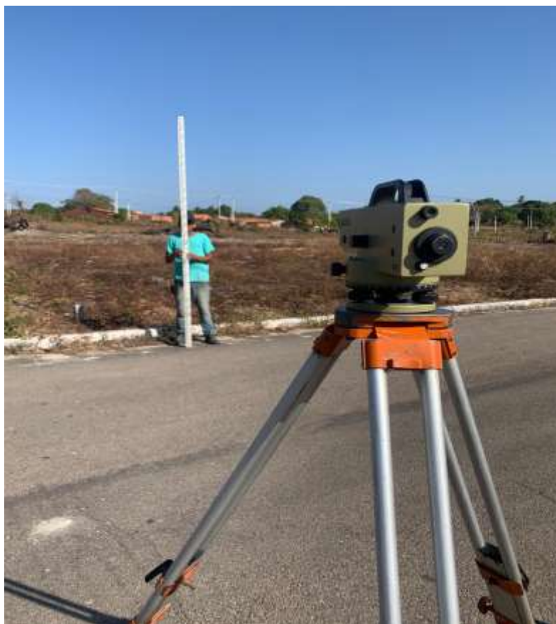
Figura 28 – Levantamento com nível e mira.
