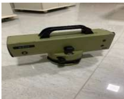
Figura 22 – Nível FOIF DS05, Mira, Tripé em Metal
