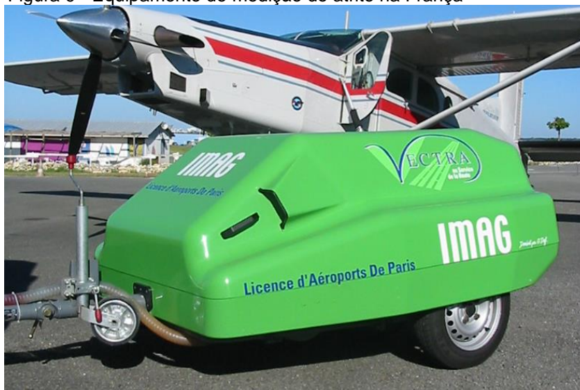
Figura 9 - Equipamento de medição do atrito na França
