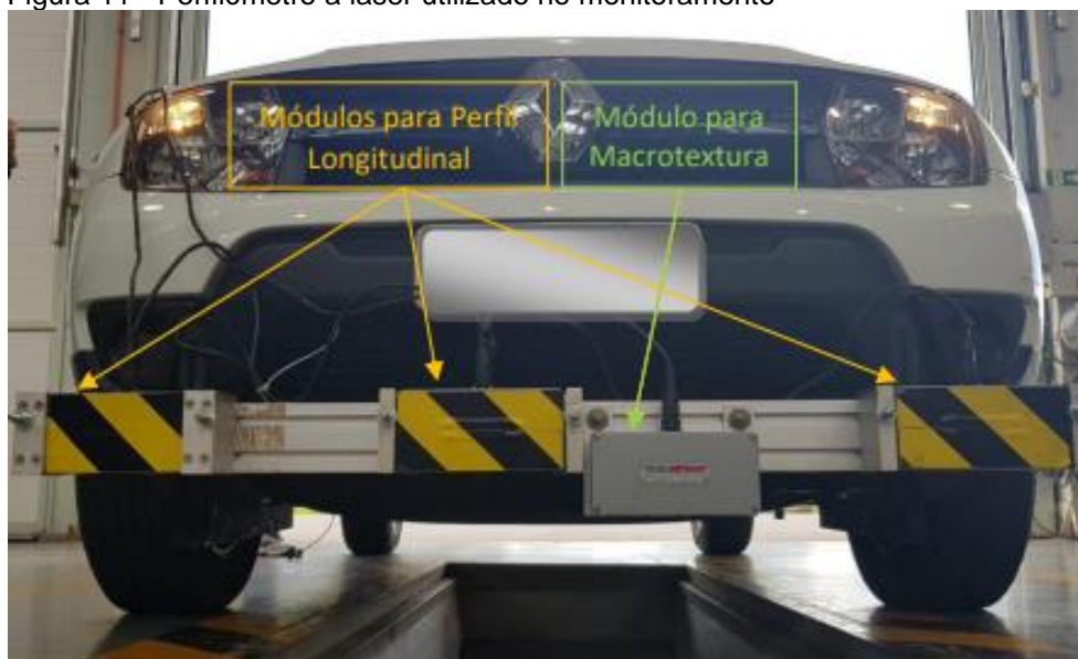
Figura 11 - Perfilômetro a laser utilizado no monitoramento
