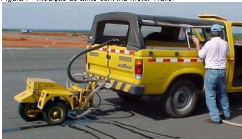
Figura 7 - Medição de atrito com Mu-meter Trailer
