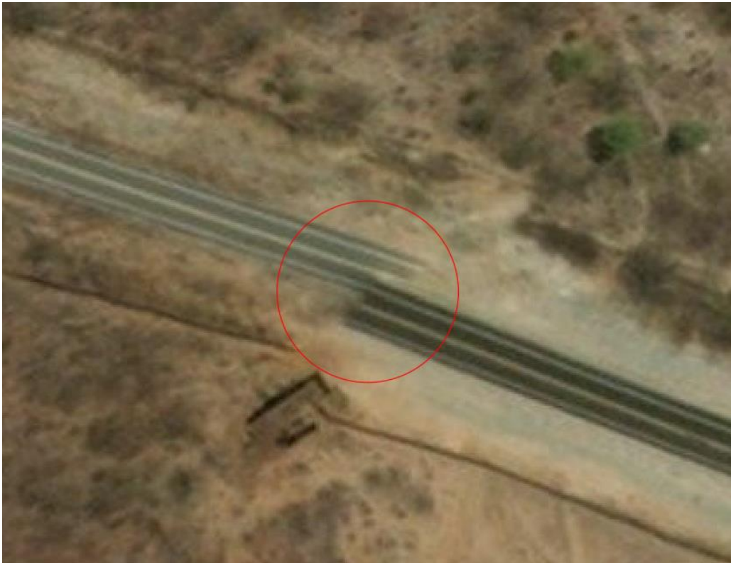
Figura 23 – Corte de imagens causando desencontro entre os eixos da rodovia
