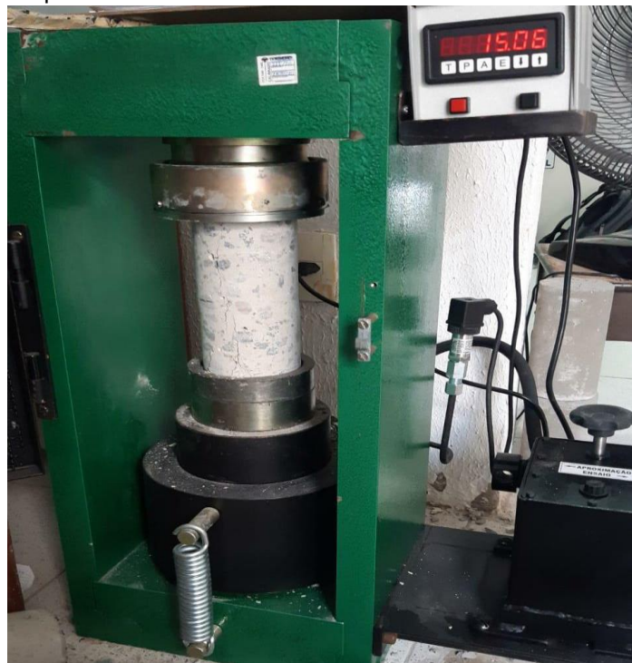
Figura 16 - Ensaio de resistência a compressão em corpos de prova extraídos.
