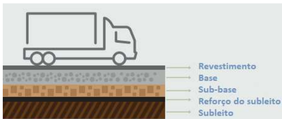
Figura 4 – Camadas do pavimento flexível
