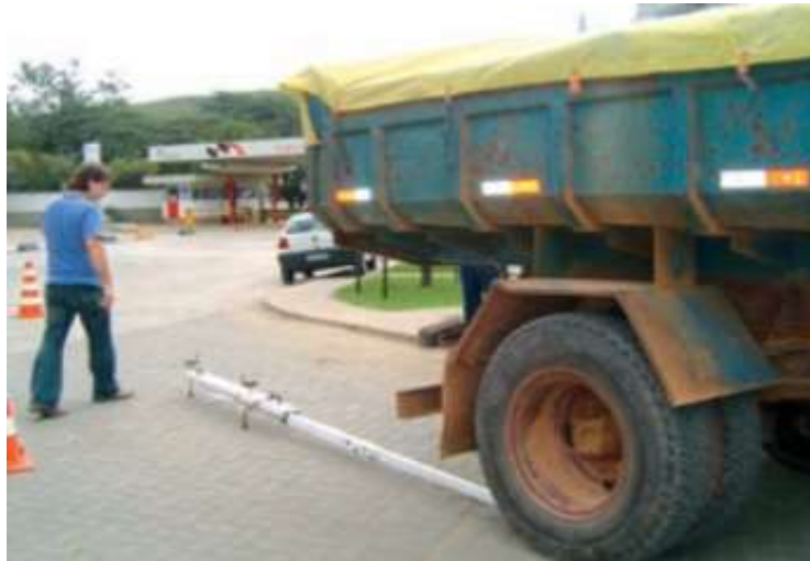
Figura 20 – Ensaio com a viga Benkelman
