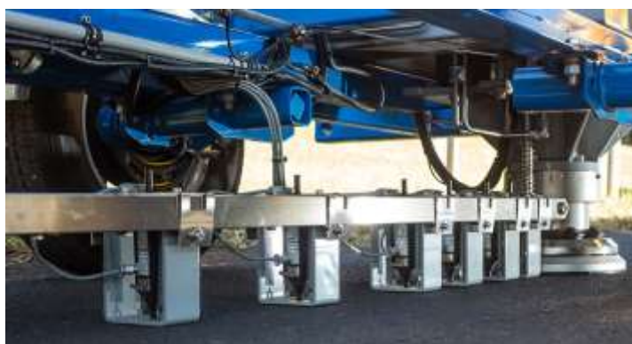
Figura 22 – Barra de sensores e prato de aplicação de carga do FWD
