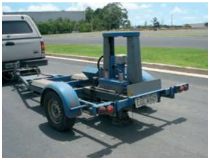
Figura 21 – Deflectômetro de impacto (FWD)
