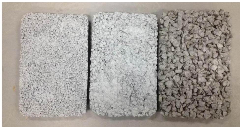
Figura 2 – Corpos de prova de concreto com diferentes agregados
