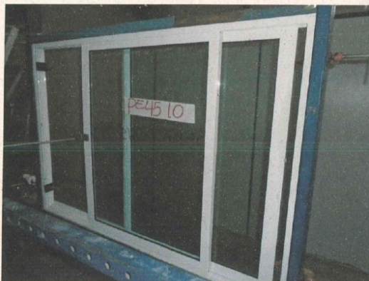
Foto nº. 09 Ensaio de resistência a flexão, do lado interno para o externo.
