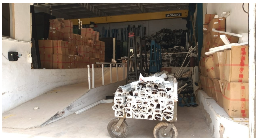
Figura 16 – Estoque dos perfis separados para fabricação das esquadrias
