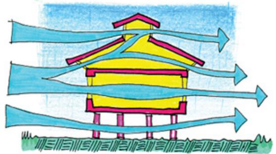
Figura 10 – Exemplos de ventilação vertical.
