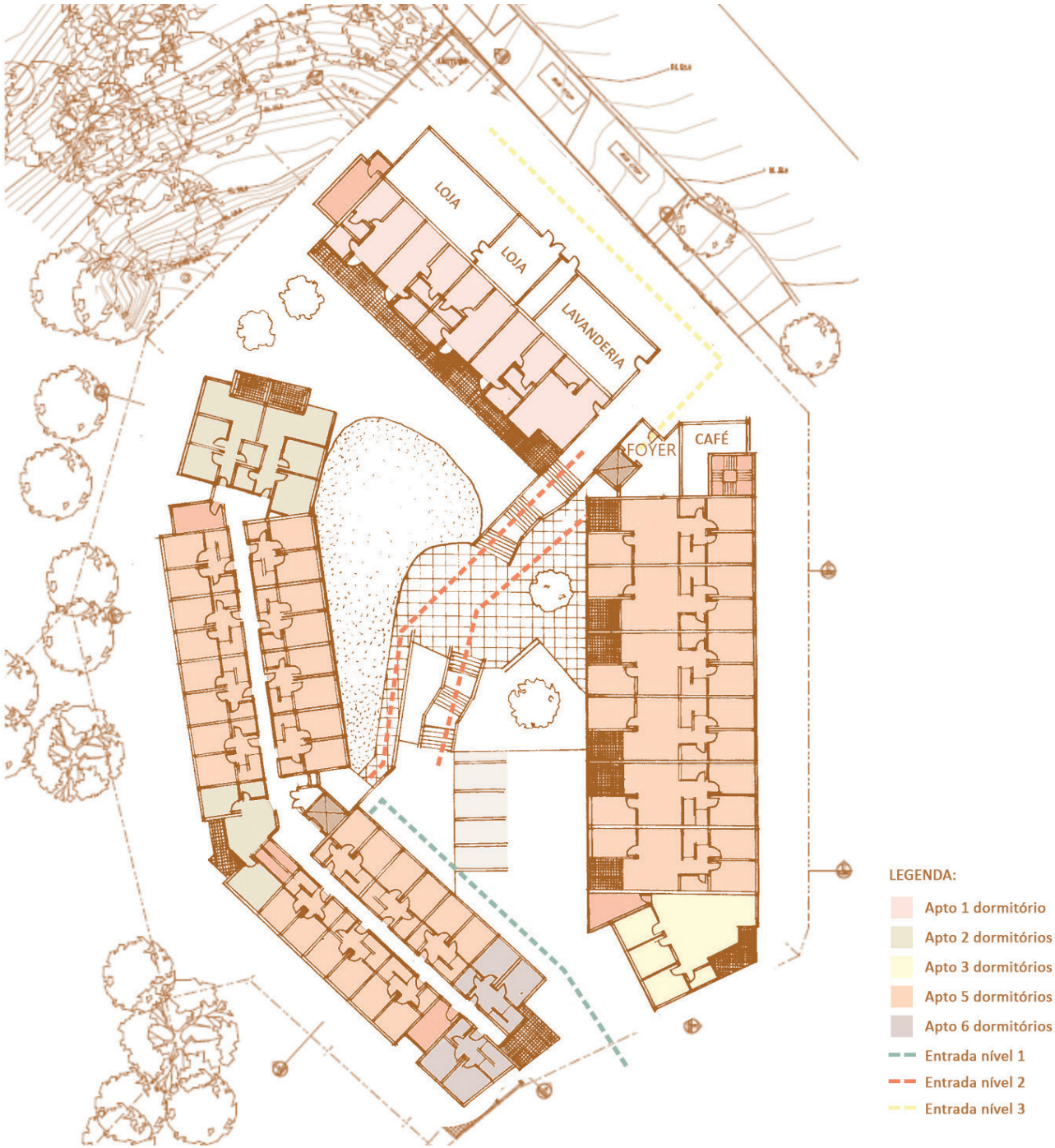
Figura 15: Planta baixa do nível térreo. Fonte: Adaptado de Ashley Brown( http://ashbrowndab810.blogspot.com/ ).
