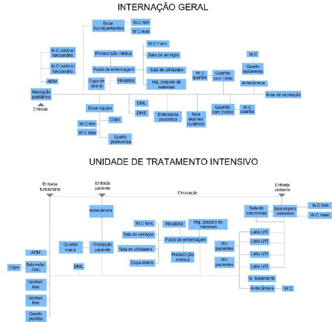
Figura 44: Fluxograma do setor de apoio a internação
