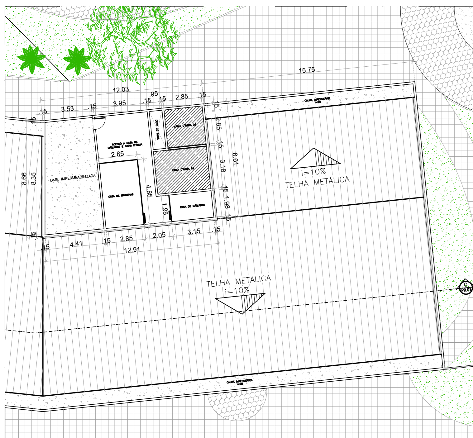
04 DETALHE- CAIXA DÁGUA/BLOCO B ESCALA 1:175
