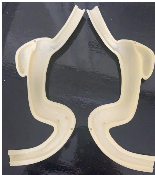
Figura 26: Molde impresso em impressora 3D de peça interna representando esôfago e duodeno normais, com estômago operado pela técnica Sleeve Gastrectomy com representação de bolsa fistulosa crônica ao nível do Ângulo de Hiss.
