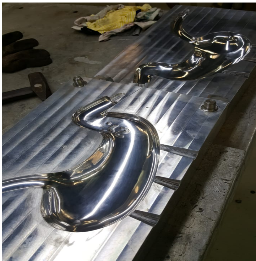
Figura 10: Molde metálico em baixo relevo para injeção de TPE.
