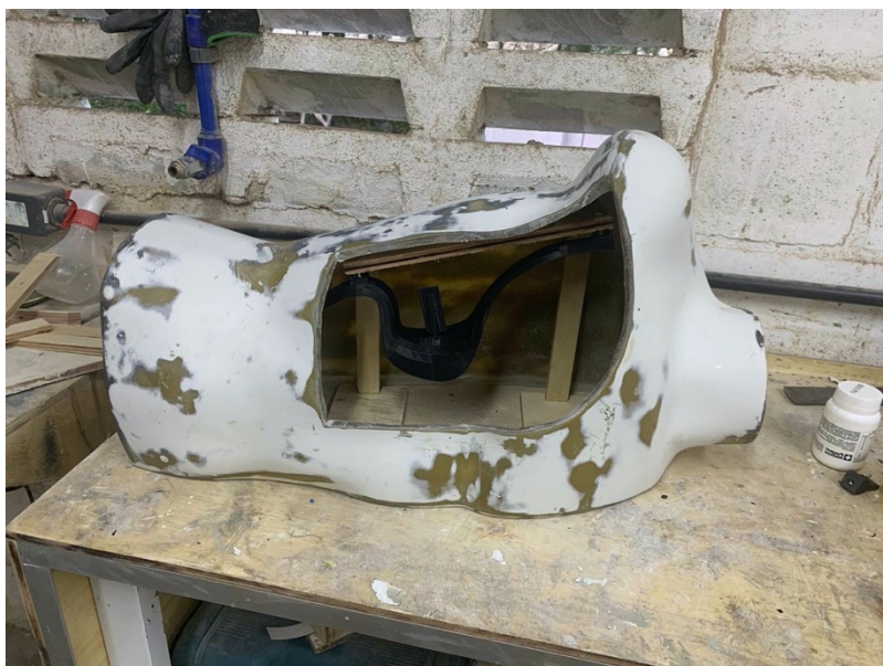
Figura 15: Início da confecção do arcabouço do modelo – estrutura oca em fibra de vidro seccionada para formação de uma claraboia ampla.
