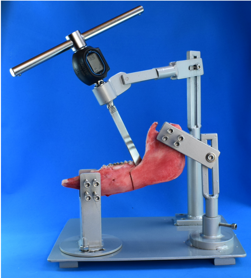
Figura 6. Equipamento de teste com uma mandíbula de porco e o osteótomo conectado ao medidor de torque.
