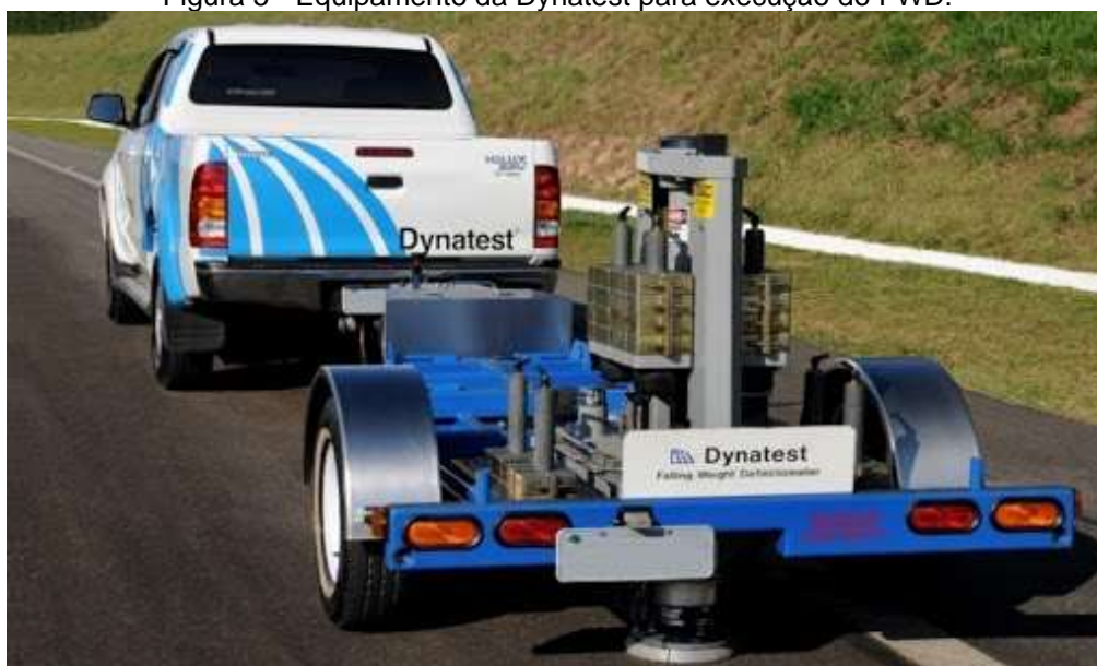
Figura 5 - Equipamento da Dynatest para execução do FWD.
