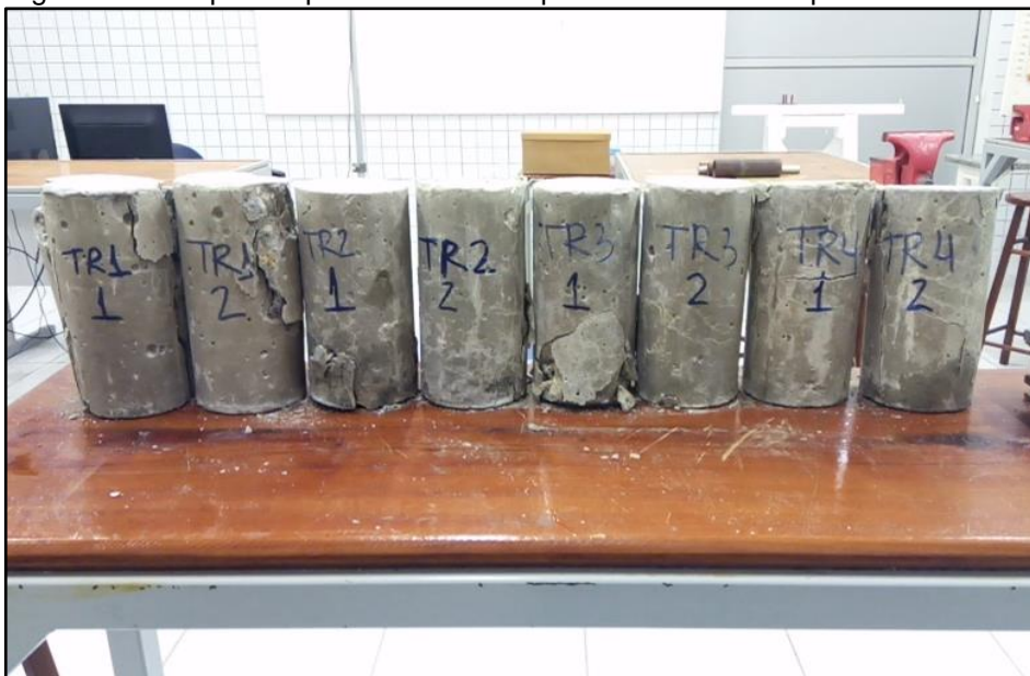
Figura 25 – Corpos de prova cilíndricos após o ensaio de compressão.
