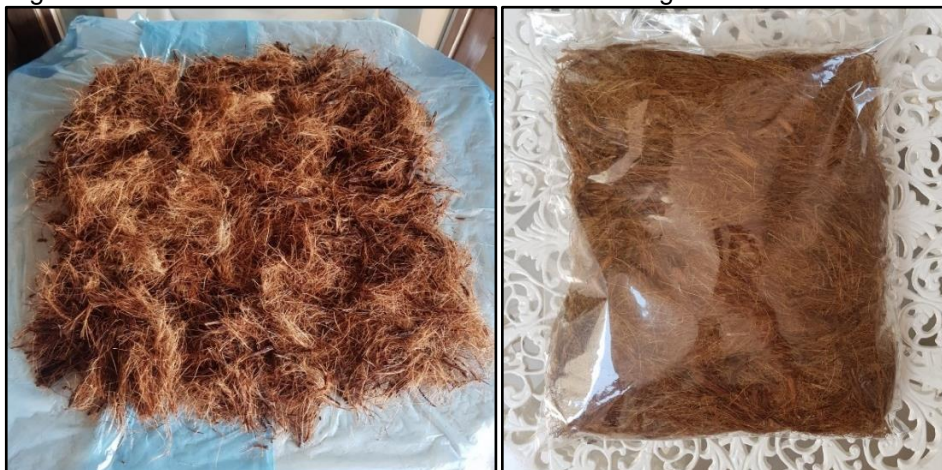
Figura 16 – Fibras de coco secando ao ar livre e em seguida ensacadas.
