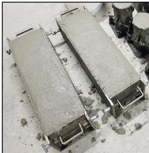
Figura 19 – Corpos de prova prismáticos moldados.
