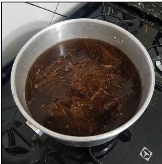
Figura 15 – Processo de aquecimento das fibras de coco.
