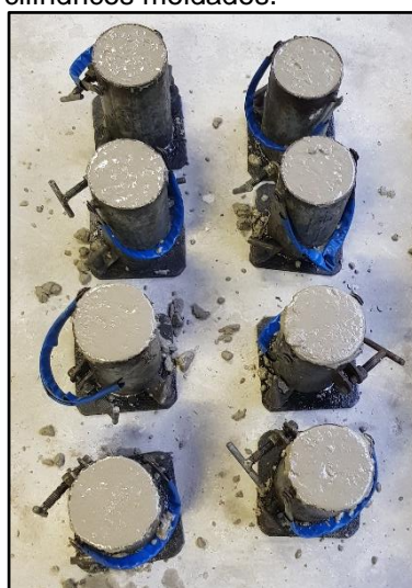
Figura 18 – Corpos de prova cilíndricos moldados.
