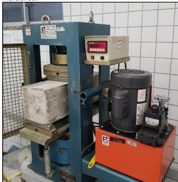
Figura 24 – Corpo de prova prismático na prensa hidráulica.
