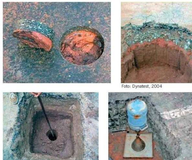
Figura 10 - Exemplo de extração de corpos-de-prova e de poços
