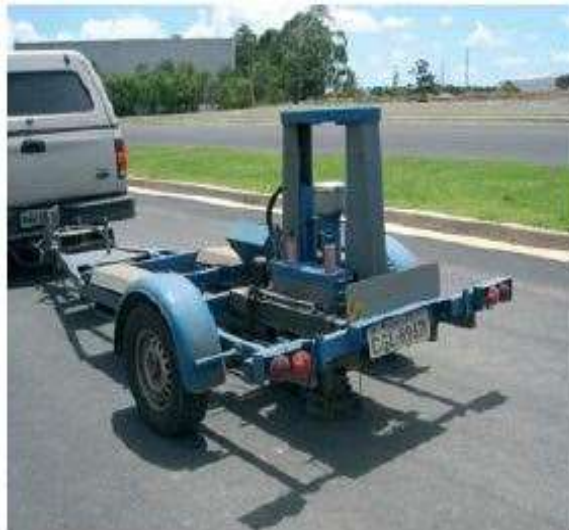
Figura 17 - Vista geral do FWD Dynatest
