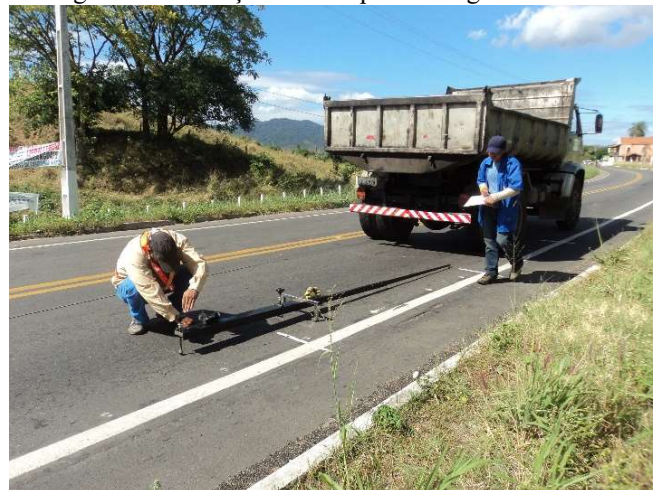
Figura 14 - Medição em campo com viga Benkelman
