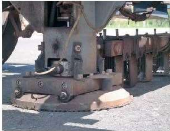
Figura 18 - Esquema de defletômetro de impacto
