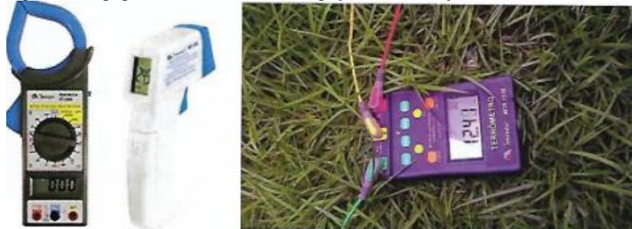
Figura 6 – Equipamentos utilizados na inspeção das instalações elétricas
