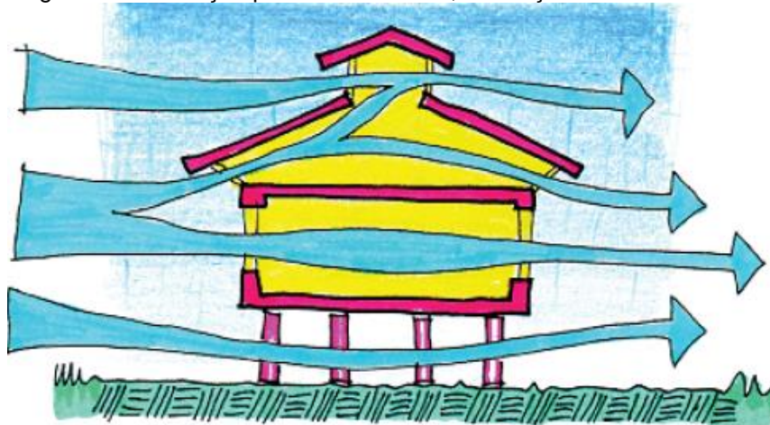
Figura 30: Ventilação por efeito chaminé, ventilação cruzada
