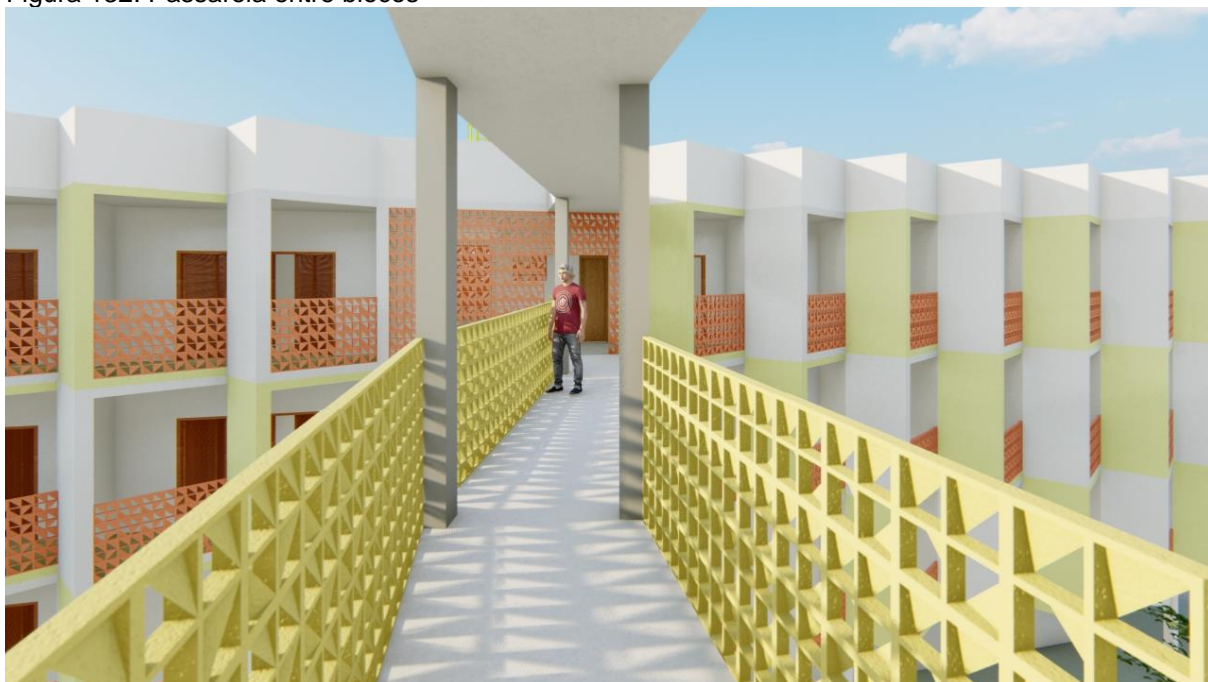
Figura 132: Passarela entre blocos
