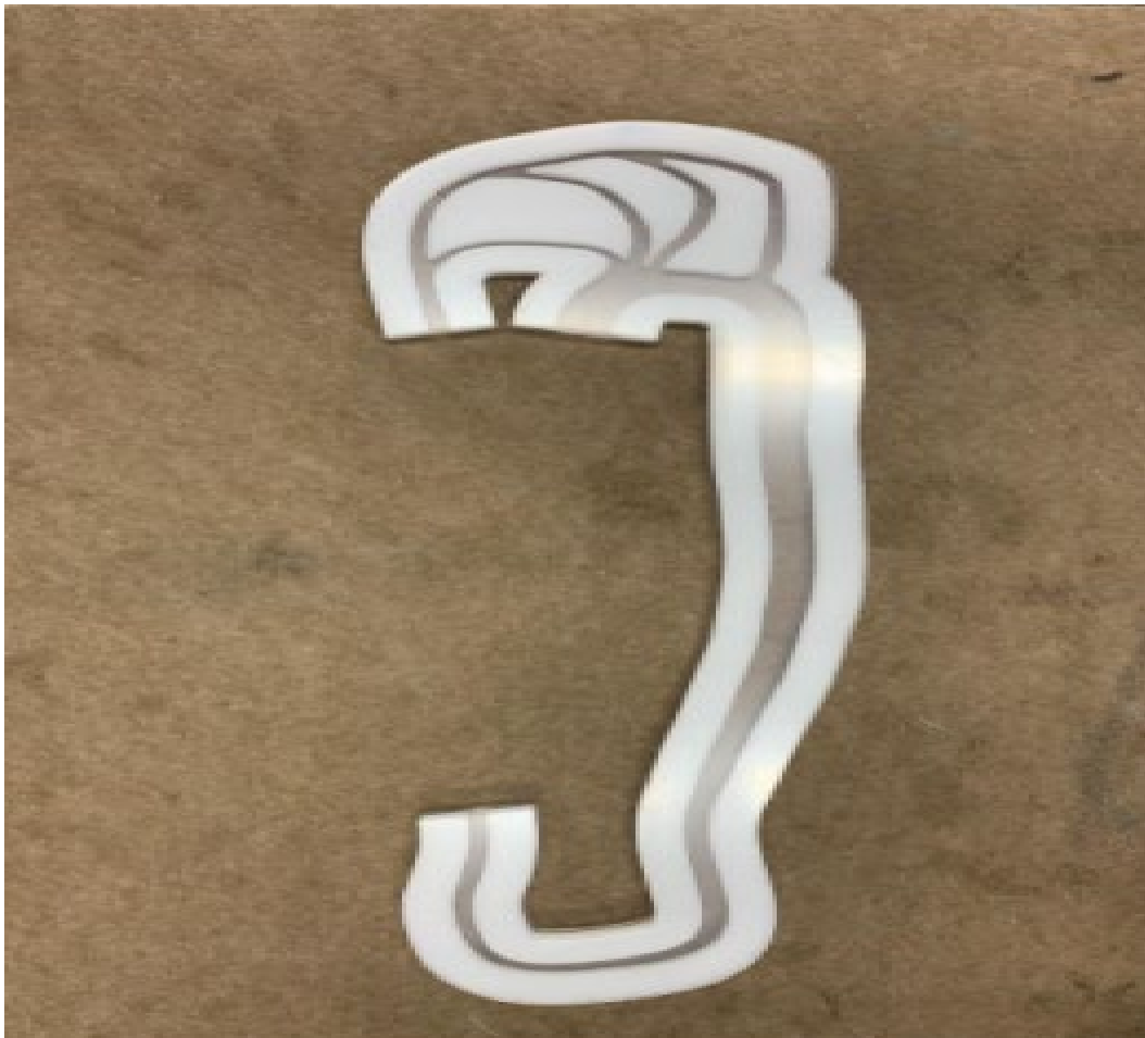
Figura 13 . Modelo final em 2D de acrílico já com as medidas e diâmetros dos vasos em proporção. Fonte: O autor.
