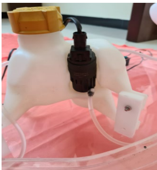
Figura 16. Bomba de fluxo de líquido acoplado ao reservatório de água. Fonte: O autor.
