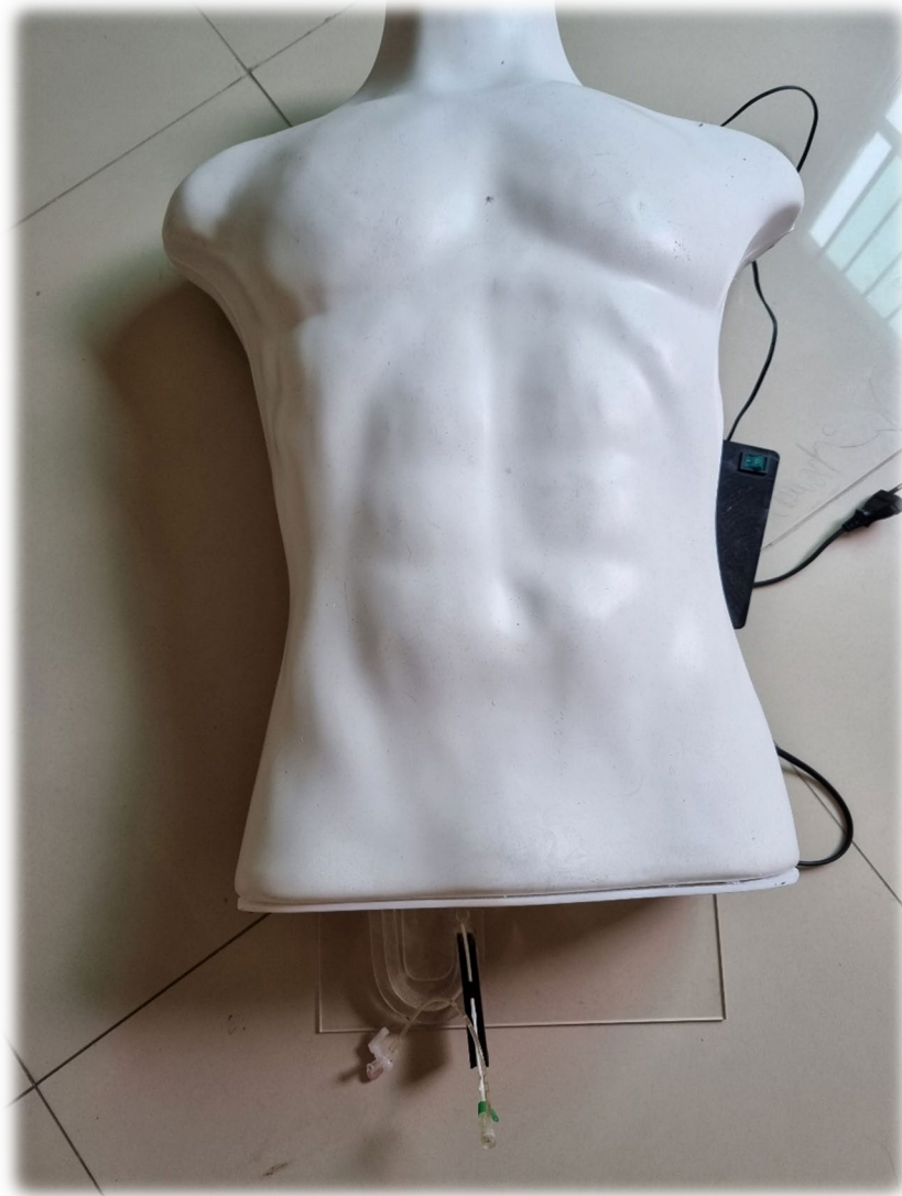
Figura 29. Simulador pronto com manequim de polipropileno recobrimdo toda a parte hidráulica e mecânica. Fonte: O autor.
