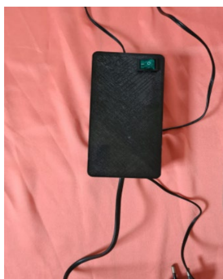
Figura 17. Fonte de conversão de tensão de 220V – 12V. Fonte: O autor.
