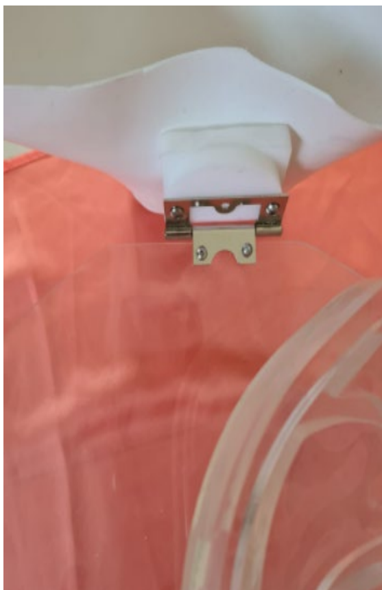
Figura 22. Dobradiça de aço inox comunicando a base de plástico com o manequim. Fonte: O autor.
