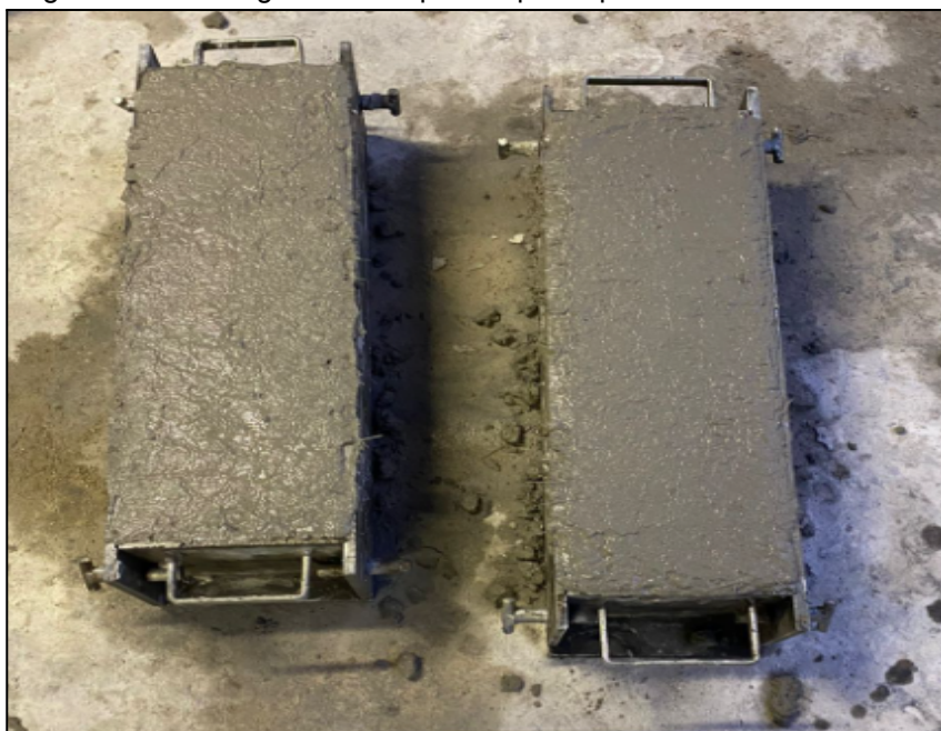
Figura 12 – Moldagem dos corpos de prova prismáticos.
