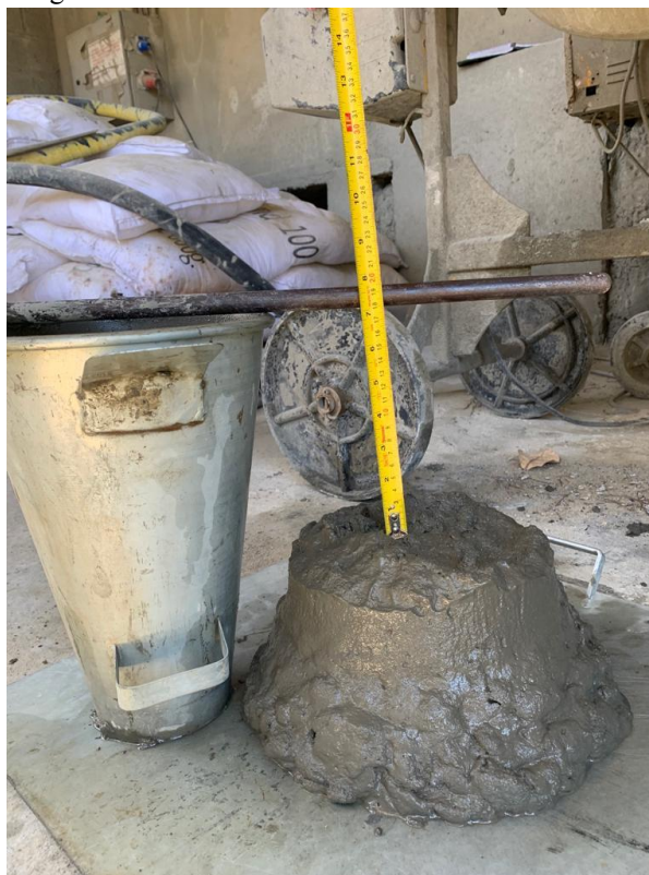
Figura 6 – Ensaio de abatimento do tronco de cone
