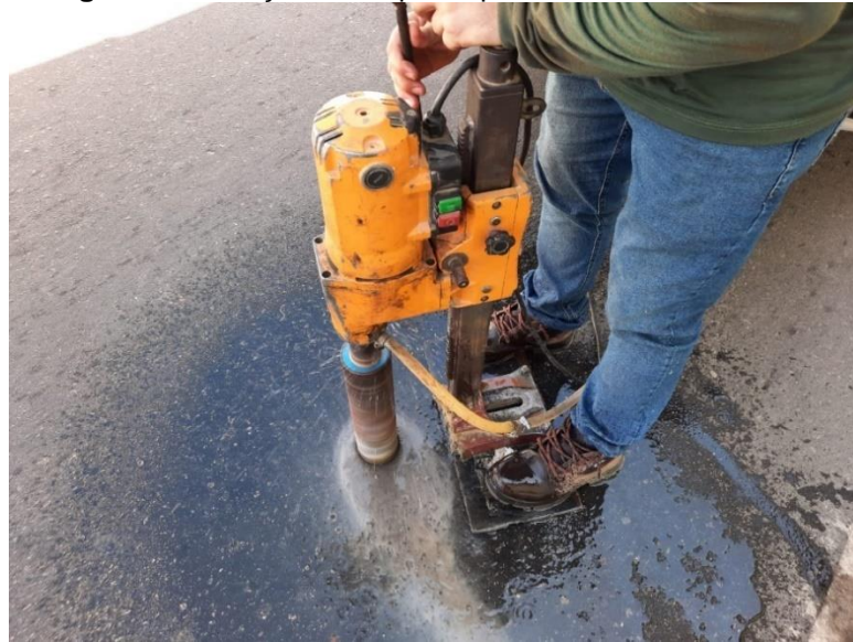
Figura 2 - Extração de corpo de prova com sonda rotativa.
