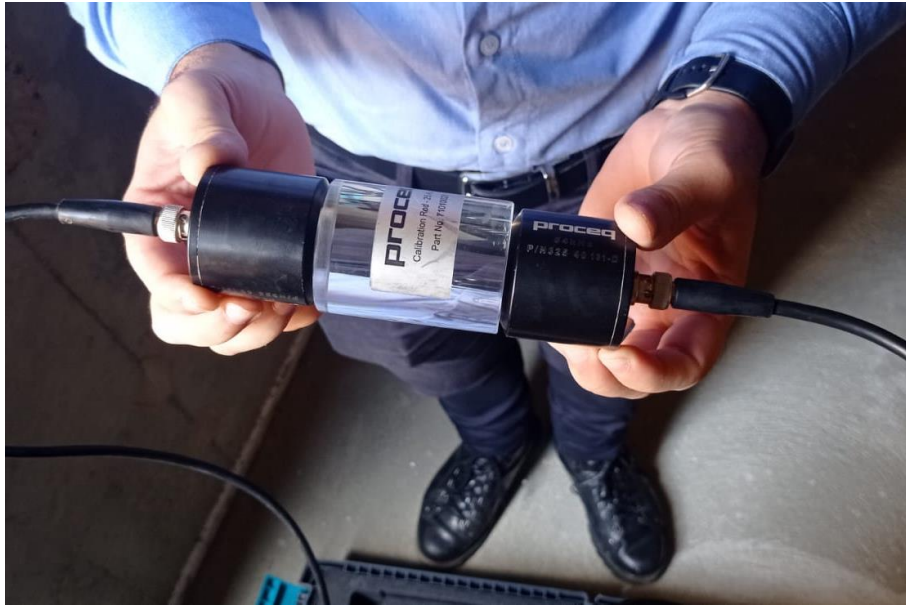
Figura 21 - Calibração dos transdutores.
