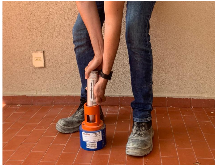
Figura 20 - Calibração do esclerômetro com a bigorna.
