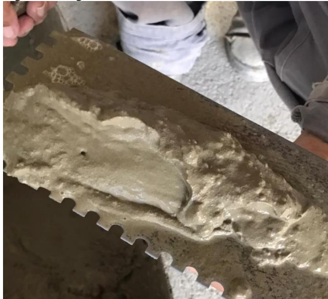
Figura 8 – Argamassa de assentamento.
