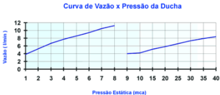
Figura 4: Curva de vazão do chuveiro elétrico
