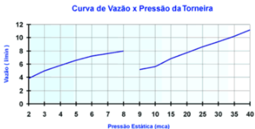
Figura 6: Curva de vazão da torneira elétrica
