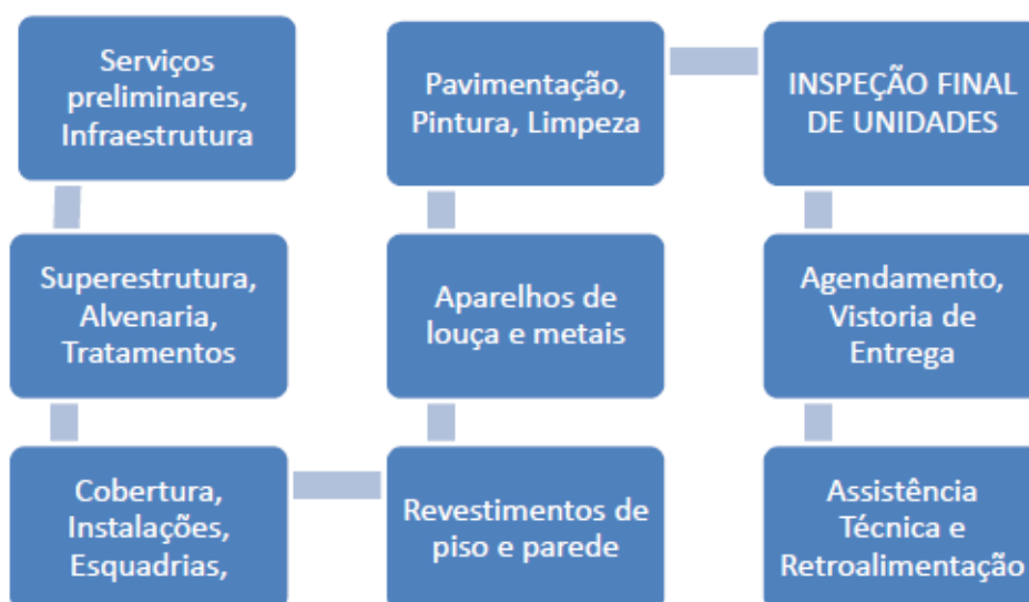
Figura 6 - Etapas da obra, com destaque para a inspeção final.
