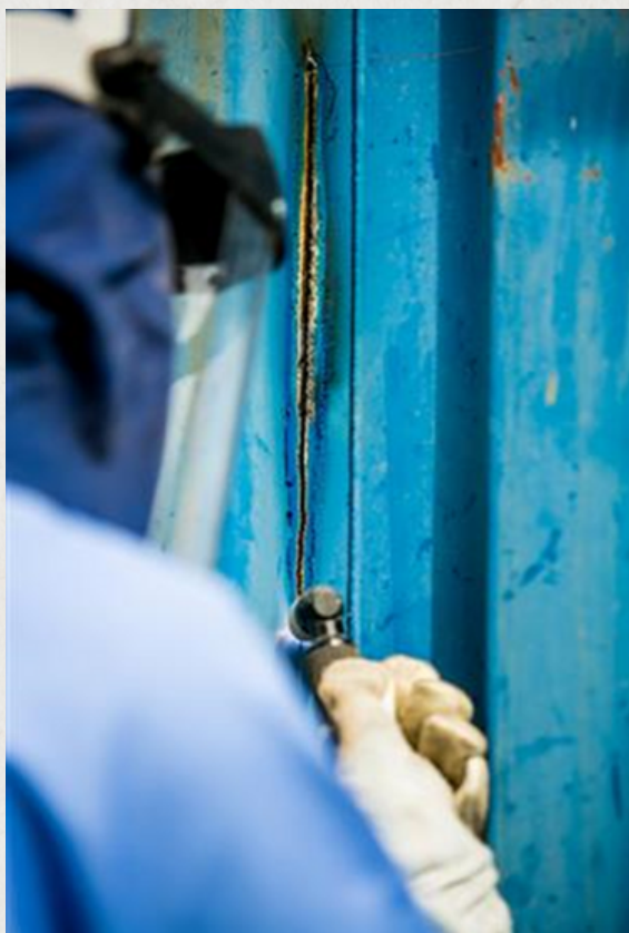
Figura 19: Corte do container
