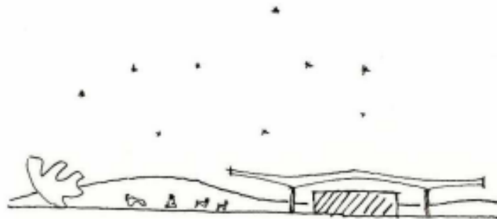
Figura 12 - Beirais que protegem as fachadas e criam áreas de estar ventiladas.
