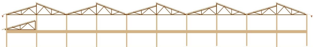
Figura 68 – Maquete estrutural (pilares, viga e cobertura).
