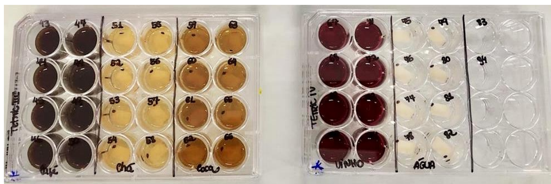
Figura 6 - Amostras imersas em 2mL das diversas soluções alimentícias: Café, Chá Preto, Refrigerante de Cola, Vinho Tinto e Água Destilada.
