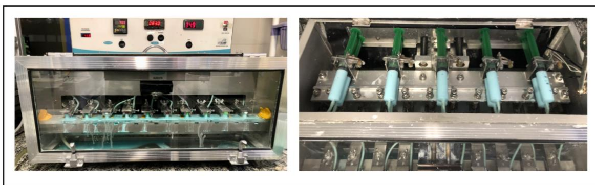
Figura 7 - Máquina de simulação de escovação (Elquip®) utilizada no estudo, evidenciando as seringas contendo uma solução de dentifrício e água destilada (1:1)
