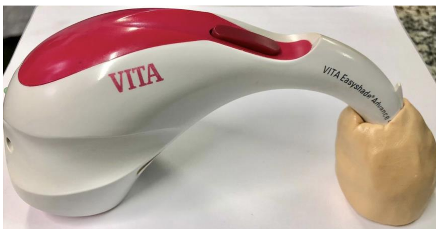
Figura 5 - Dispositivo utilizado para mensuração da cor (Vita Easychade®).
