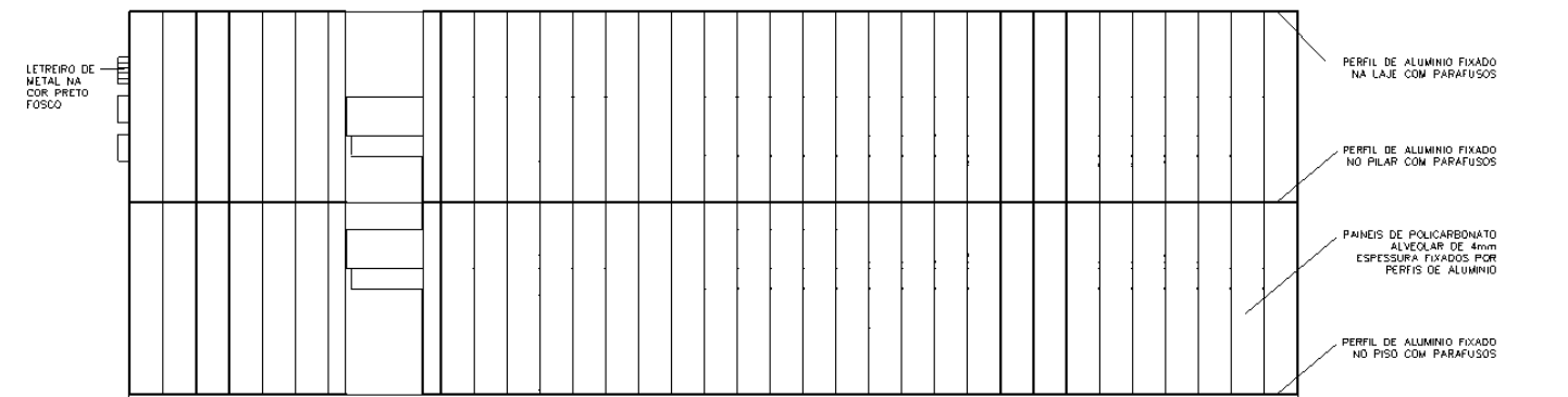
09 FACHADA 04 C/ POLICARBONATO 1:150
