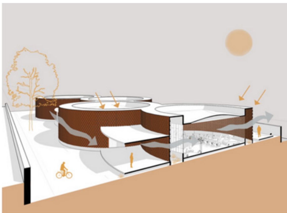
Figura 23: Esquema de ventilação- Unileão Fonte: Archdaily, 2022
