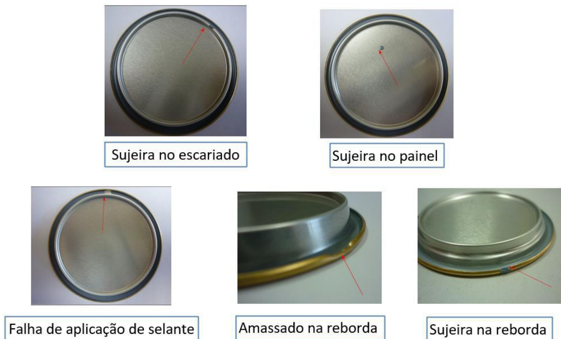
Figura 14 – Tipos de defeitos no processo de aplicação de vedante da tampa.
