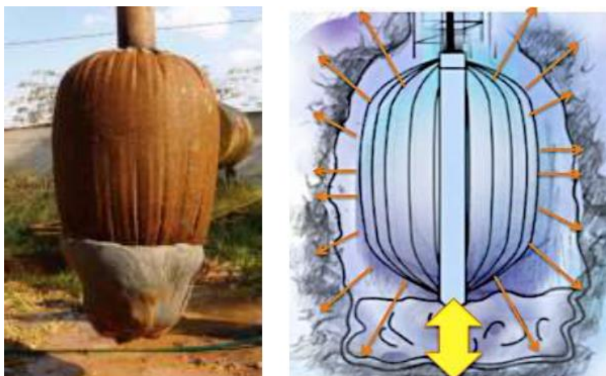
Figura 2.9 – Injeção de calda cimentícia no EB
